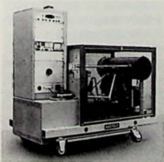
Bild 1: Generator zur Simulation des nuklearen elektromagnetischen Pulses (Haefely-Pressbild)
